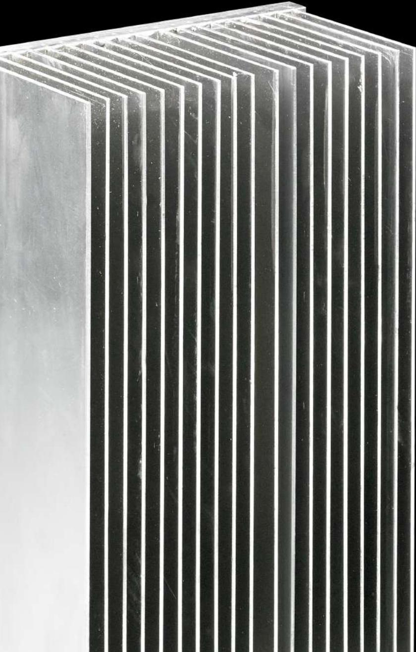
Diese Art von Kühlkörpern garantieren eine hohe thermische Leistung. Sie werden durch Verkleben von Aluminiumlamellen in Längsrillen auf einer Basis aus Aluminium oder Kupfer hergestellt. Praktisch unbegrenzte Anpassungen sind möglich. Das für die Realisierung erforderliche System ist besonders flexibel, da es keine Werkzeuge erfordert und daher keine anfänglichen Investitionskosten verursacht.
