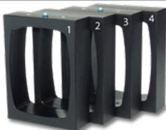
Die Bohrvorrichtungen werden auf das bereits gekürzte Rohr geschoben. Durch die Vorrichtungen wird ein stabiles Einspannen ohne Beschädigungen am Rohr ermöglicht. Die integrierten Bohrhilfen geben die Position der Gewindelöcher vor und führen den Bohrer.
