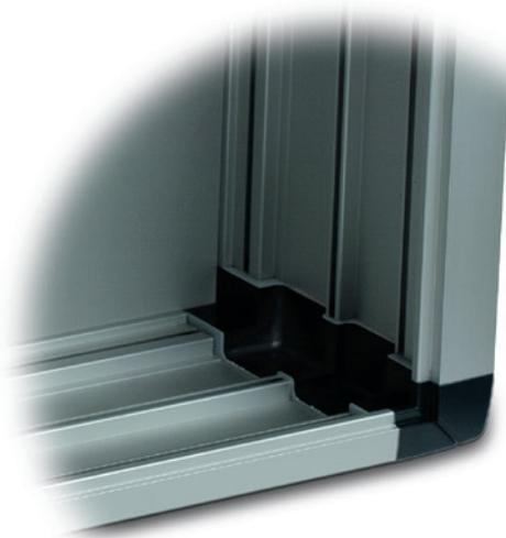
Das Aluminium-Strangprofil des CC-3000 enthält innen umlaufende Nuten (siehe Abbildung). Einzubringende Komponenten können dort ohne mechanische Bearbeitung des Gehäuses mit einfachen Federmuttern befestigt werden. Außerdem ergibt sich im Bereich der Tragsystem-Anbindung eine einfache Möglichkeit der Kabelführung.
